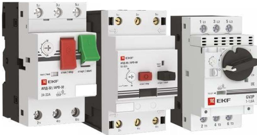
Автоматические выключатели пуска двигателя серии GV2P EKF PROxima, АД-32 EKF PROxima и АД-80 EKF PROxima с термомангнитным расцепителем специально предназначены для коммутаций цепей переменного тока напряжением до 690 В частотой 50/60 Гц, а также для управления и защиты трехфазных асинхронных двигателей от перегрузки, обрыва фазы, короткого замыкания.
