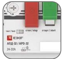
Защита от тока перегрузки, пропадания фазы (срабатывает по тепловому току оставшихся двух фаз), защита от КЗ (специально для двигателя ток отсечки 13 \*In)
