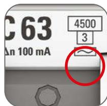
**S** **Селективные** – специально предназначены для выдержки заранее установленного значения предельного времени неотключения при протекании дифференциального тока.
