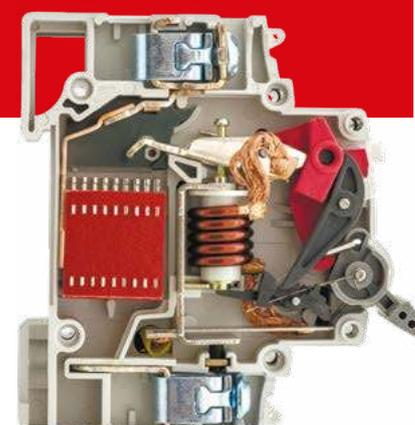
Дифференциальный автоматический выключатель АД-32 EKF PROxima представляет собой аппарат, сочетающий функции автоматического выключателя с устройством защитного отключения. При обнаружении автоматическим выключателем в защищаемом участке сети тока утечки (повреждения) на землю или сверхтока (тока перегрузки или короткого замыкания) происходит срабатывание устройства, приводящее к отключению защищаемой сети.
