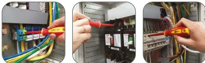
Диэлектрическая отвертка предназначена для работы с крепежом, который используется в электротехнических устройствах, находящихся под напряжением. Благодаря специальному изоляционному покрытию исключается риск поражения пользователя током, даже когда напряжение достигает 1000 В.
