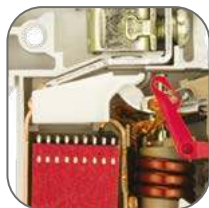
Рабочая зона закрыта диэлектриком
