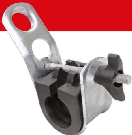
Зажимы промежуточные PS425, PS435, PS450, PS470 используются для крепления 2 или 4 проводов и обеспечивают подвеску на промежуточных опорах с углом поворота до 30°. Зажимы снабжены гайкой-барашком.
