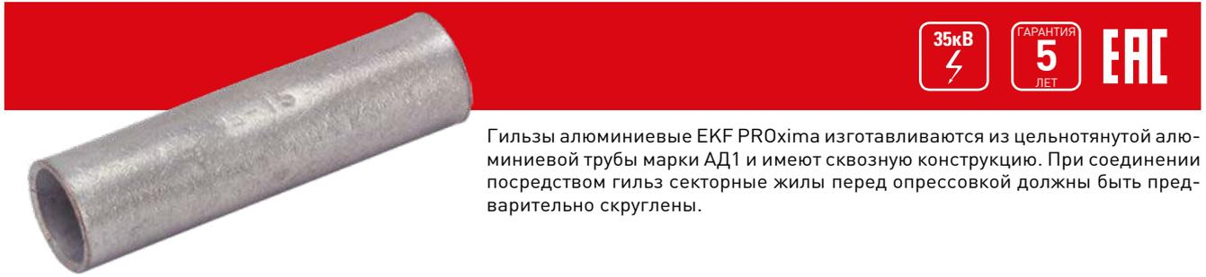
Гильзы алюминиевые EKF PROxima изготавливаются из цельнотянутой алюминиевой трубы марки АД1 и имеют сквозную конструкцию. При соединении посредством гильз секторные жилы перед опрессовкой должны быть предварительно скруглены.
