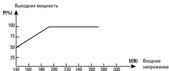
Если входное напряжение находится в диапазоне 190–250В, стабилизатор может обеспечивать 100% максимальной выходной мощности, указанной в спецификации. Максимальная выходная мощность будет изменяться в соответствии с кривой на рисунке.
