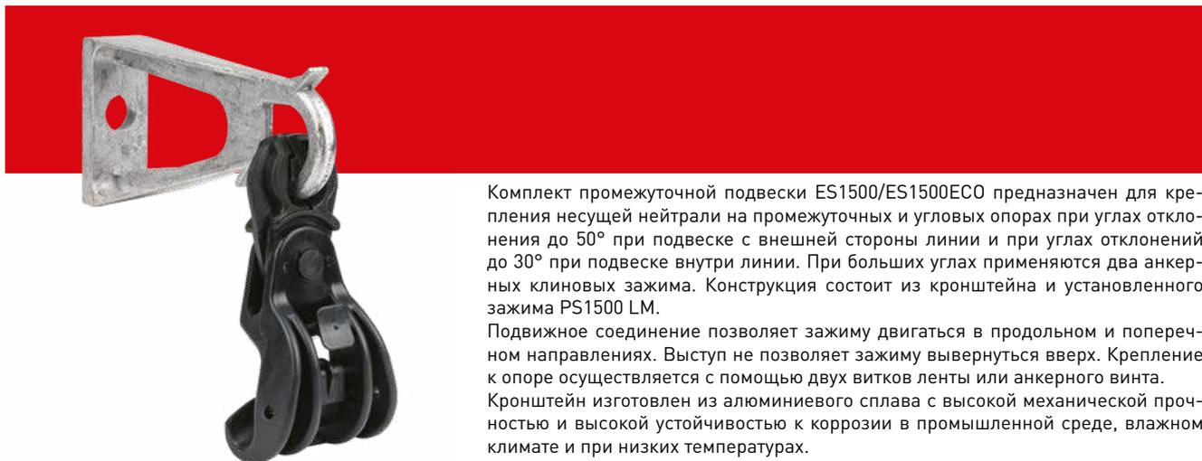
Комплект промежуточной подвески ES1500/ES1500ECO предназначен для крепления несущей нейтрали на промежуточных и угловых опорах при углах отклонения до 50° при подвеске с внешней стороны линии и при углах отклонений до 30° при подвеске внутри линии. При больших углах применяются два анкерных клиновых зажима. Конструкция состоит из кронштейна и установленного зажима PS1500 LM.
