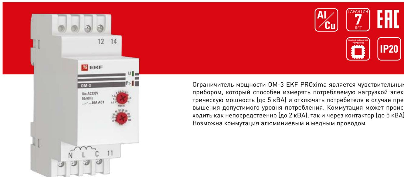
Ограничитель мощности OM-3 EKF PROxima является чувствительным прибором, который способен измерять потребляемую нагрузкой электрическую мощность (до 5 кВА) и отключать потребителя в случае превышения допустимого уровня потребления. Коммутация может происходить как непосредственно (до 2 кВА), так и через контактор (до 5 кВА). Возможна коммутация алюминиевым и медным проводом.
