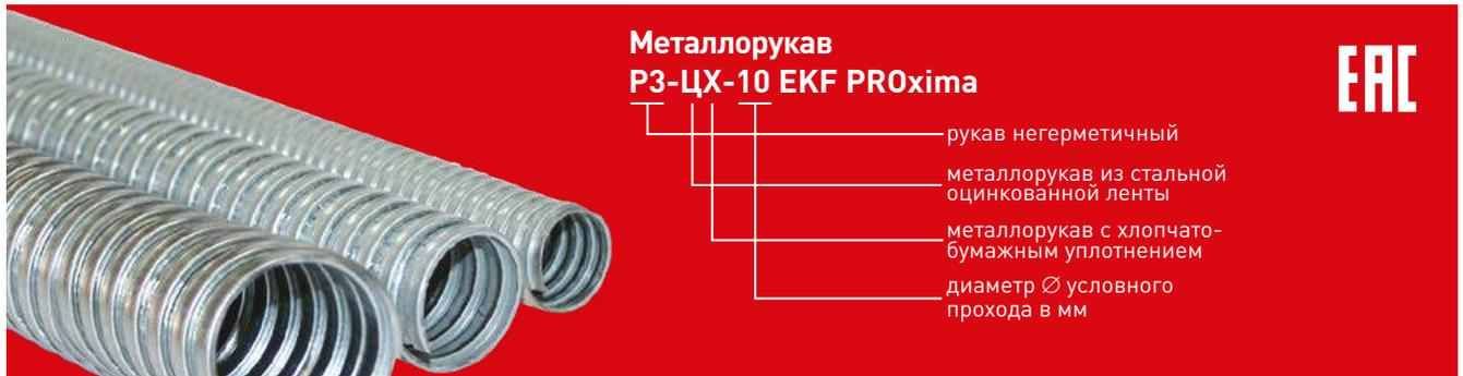
Металлорукава в бухтах – гибкие негерметичные типа P3-ЦХ EKF PROxima, изготавливаются из оцинкованной стали с хлопчатобумажным уплотнением, которая не подвергается коррозии и упаковывается в бухты. Дополнительной защитой металлорукава серии P3 ЦХ EKF является слой минерального масла и эмульсии, которые наносятся на его поверхность в процессе навивки для предотвращения повреждения оцинкованного покрытия.
