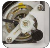
Настройка нулевого положения стрелки
