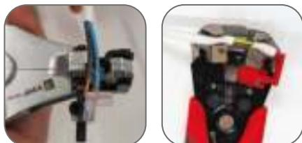
Правильная разделка кабеля и снятие изоляции с провода без повреждения токоведущей жилы являются основой качественного электромонтажа.
