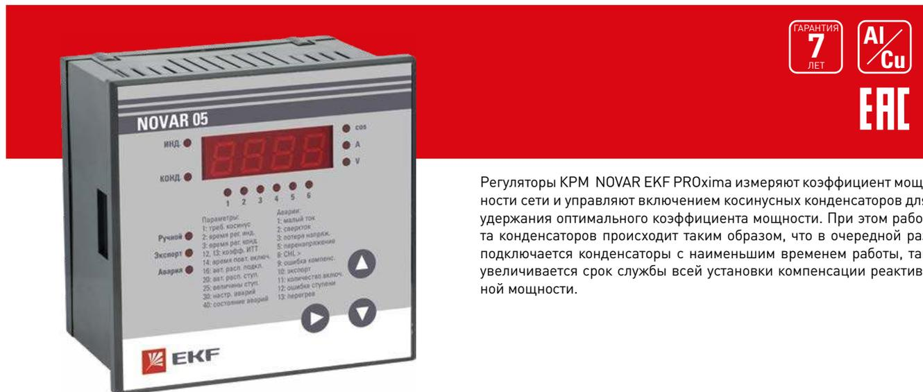
Регуляторы KPM NOVAR EKF PROxima измеряют коэффициент мощности сети и управляют включением косинусных конденсаторов для удержания оптимального коэффициента мощности. При этом работа конденсаторов происходит таким образом, что в очередной раз подключается конденсаторы с наименьшим временем работы, так увеличивается срок службы всей установки компенсации реактивной мощности.
